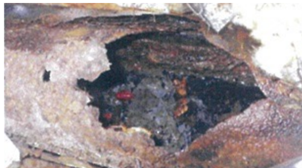
築29年目の排水鉄管の横引主管の劣化
